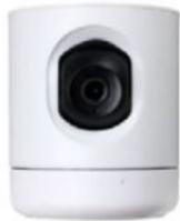
**Panoramic Camera** IP/Wifi 1MP H264, ottica fissa 3,6mm, Pan orizzontale di 355° e Tiltmanuale verticale di 30°+30°. Porta Ethernet 10/100Mbit e Wifi 802.11 b/g/n 2,4Ghz confunzione P2P diretta. Slot per SD Card fino a 64GB, alimentazione 5VDC.
